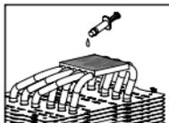
Tragen Sie eine hauchdünne Schicht Wärmeleitpaste auf der Oberfläche der CPU und auf der Unterseite des Kühlers auf.
